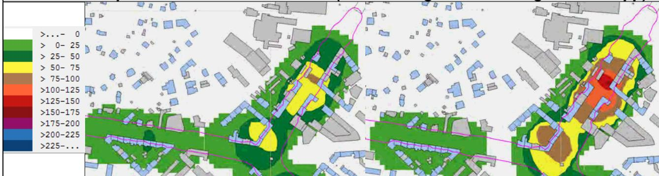
LKZ-Wert Für Pegelindex L<sub>DEN</sub> mit Auslösewert 65 dB(A) (Linie magenta)
